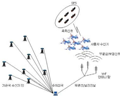
그림 3. 지상기반 광역 증가시스템의 구조
